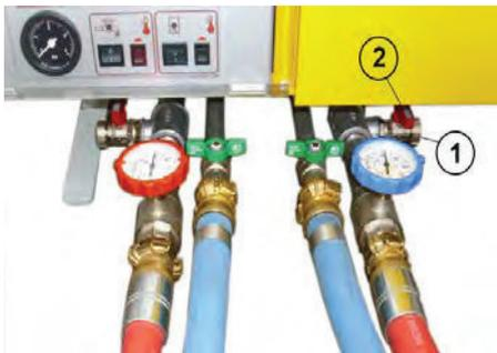
**Bild:** Schraubkappen öffnen
