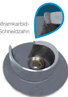
SCK Laufgrad EN-GJL-200 mit Wolframkarbid-Schneidzahn (89 HRA)
