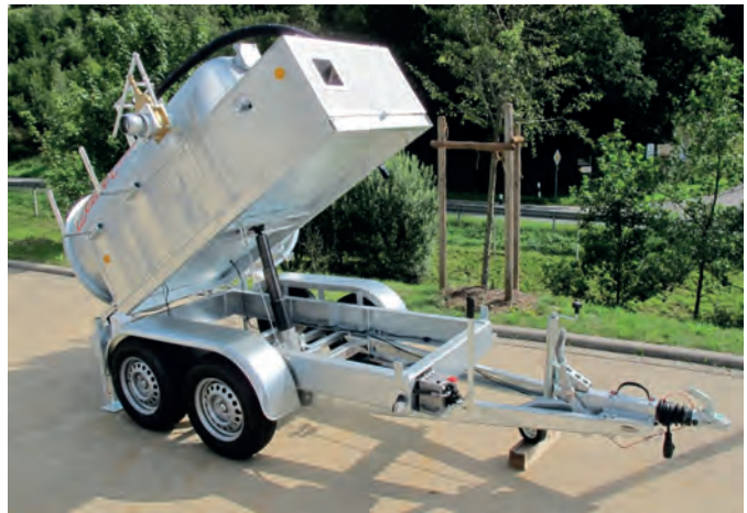
Kippbarer Vakuumfasswagen Vacuum with adjustable tilt angle
