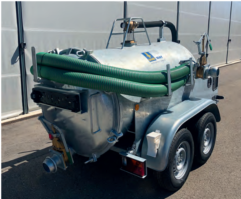
Vakuumfasswagen auf Fahrgestell Vacuum tanker mounted on chassis
